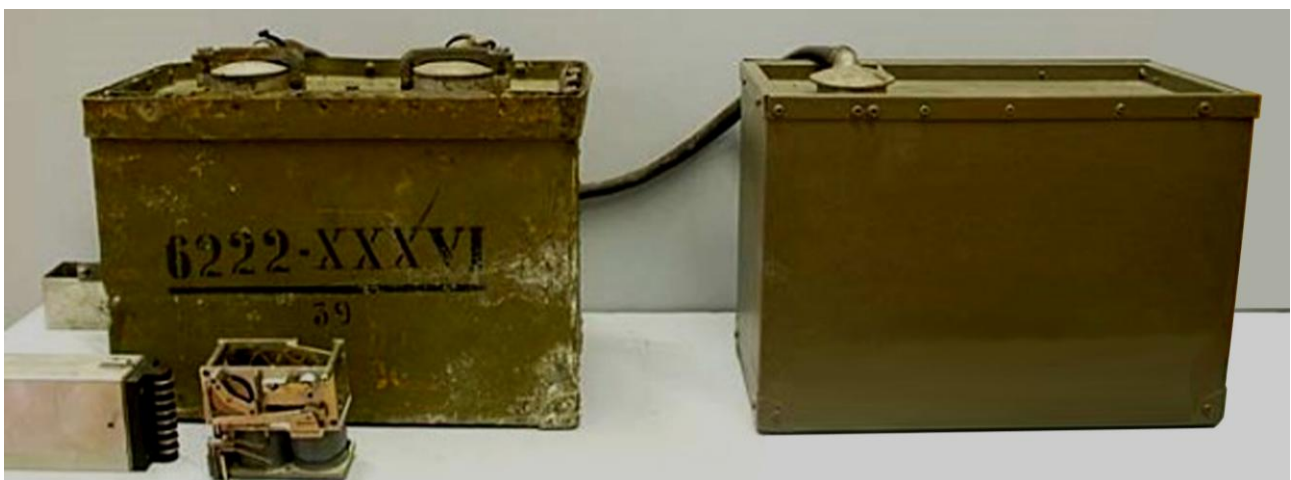
Iniciační mechanismus (Apparat F-10) a dešifrátor (Apparat A), vytažené z plechové schránky. Vpravo 12 V akumulátor, připojený pomocí dvoužilového kabelu
