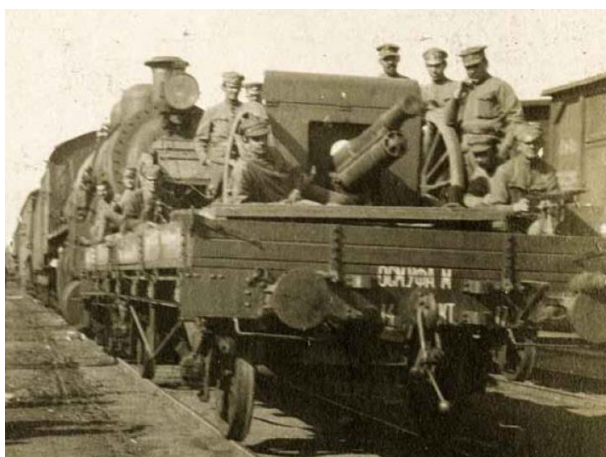
76,2 cm (třípalcový) kanón vz. 1902 na dělostřeleckém voze jednoho z obrněných vlaků Československého vojska na Rusi.
