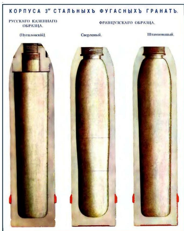
Těla trhavých granátů „ruského“ a francouzského vzoru“, vyráběná různými technologiemi.
