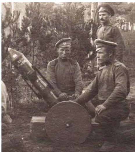
Ruští bombometčici u 58 mm minometu F. R. s nabitou těžkou svařovanou minou, adjustovanou zapalovačem 13 G. M..
